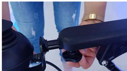
2. Branchez le faisceau de câbles du contrôleur au faisceau de fils du CPU qui s'écoule de la chaise elle-même, en prenant soin d'aligner les broches correctement afin qu'elles ne soient pas pliées, cassées ou endommagées.
