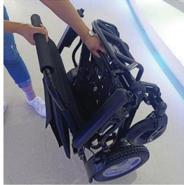
Poussez vers le bas pour fermer le loquet situé sous le siège centré à l'arrière de la Mobi pour verrouiller le siège en place. Cette étape est très importante, assurez vous que le loquet est bien fermé.
