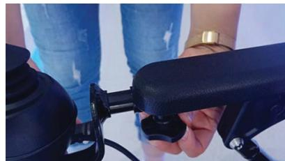
2. Branchez le connecteur du câble du contrôleur au connecteur du câble qui s'écoule de l'accoudeur de la chaise elle-même, en prenant soin d'aligner les broches correctement afin qu'elles ne soient pas pliées, cassées ou endommagées.
